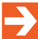
Indicación de los medios de lucha contra incendios
